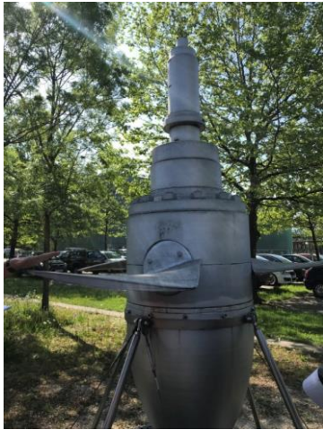
Bild: Kaplan turbine
