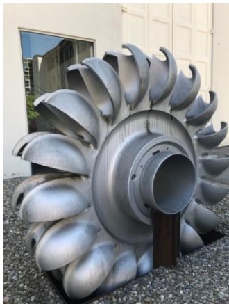
Bild: Pelton turbine
